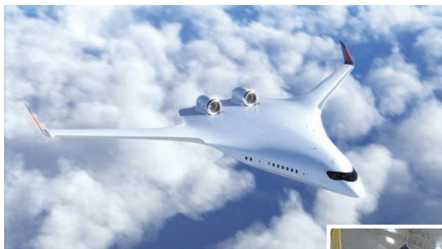
▲達美航空與JetZero聯手發展BWB融合機身飛機，塑造未來飛行的樣貌。
